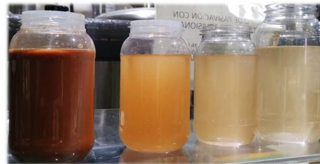
Secuencia de descontaminación en un sistema con Glycol
