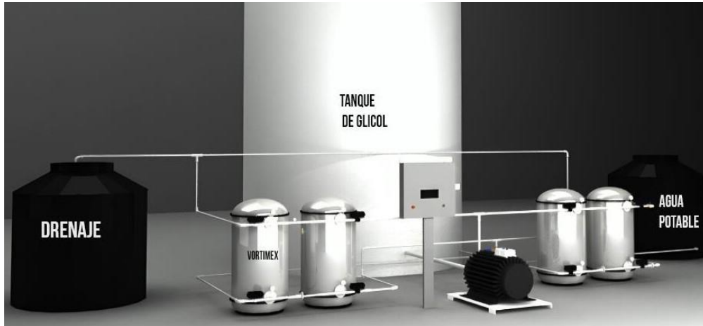
Filtros con capacidad de 4 ft3 cada uno
